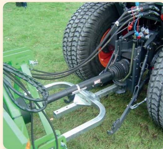
Timone idraulico da utilizzare con cardano omocinetico e/o spazzola idraulica per pulizia bordi stradali. (accessorio) Draw bar to use with wide angle pto shaf and/or with hydraulic brush for side roads cleaning. (accessory) Timon hydraulique pour emploi avec cardan grand angle et ou balai hydraulique pour le nettoyage des bords de route (accessoire) Zugdeichsel zur Verwendung mit Weitwinkel-Gelenkwelle und/oder hydraulischer Seitenbürste zum Straßenränder-Auskehren (optional).
