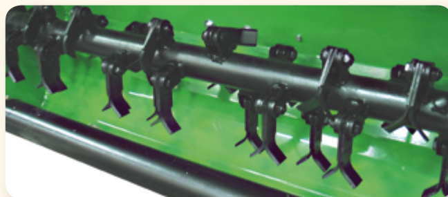
Vista albero coltelli / Flail shaft view. / Vue du rotor / Messerwelle foto
